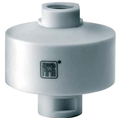
Diese Druckmittler dienen der Trennung von z.B. korrosiven, aggressiven oder pastösen Druckmedium bei Manometern, Druckschaltern und Druckmessumformern. Eine elastische Membrane ist mechanisch fixiert. Ein serienmäßiger Lecktest gewährleistet eine zuverlässige Trennung des Druckmediums von der Übertragungsflüssigkeit, mit der der Druckmittler befüllt ist. Typische Anwendungen finden sich z.B. in der Galvanik, Wasseraufbereitung und Leiterplattenherstellung.
